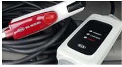
ICCB laddkabel (ansluts till vanligt vägguttag, min 10A)
